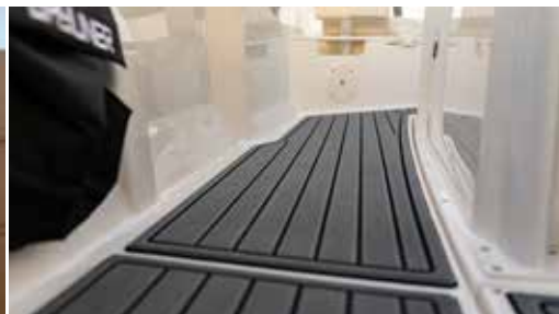
Grauer rutschfester Bodenbelag
